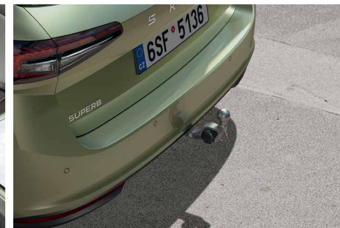
Tažné zařízení sklopné, elektricky odjistitelné
